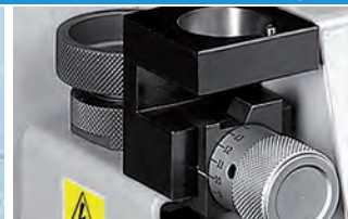
Regolazione della lunghezza e posizionamento della punta
