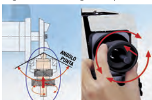
Regolazione della lunghezza e posizionamento della punta
