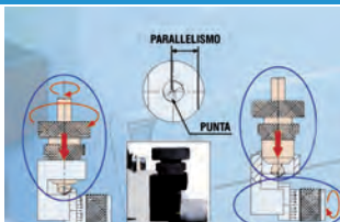
Regolazione della lunghezza e posizionamento della punta
