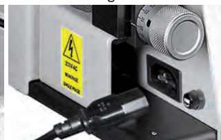
Cavo di collegamento elettrico e fusibile
