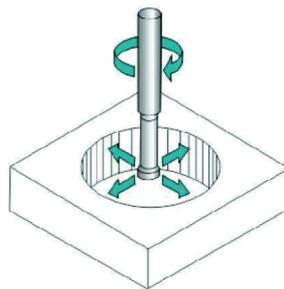
Misurazione del diametro interno.
