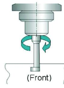
3. Mantenere una distanza tra cilindro e superficie pari al raggio di rotazione di 5mm.
