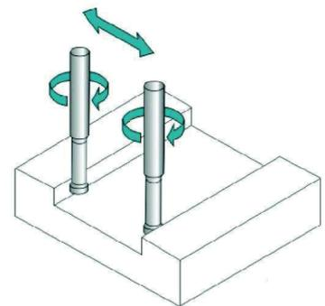
Misurazione fessure e scanalature.
