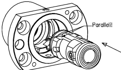
1—Setzen Sie den HN63C-Spannzylinder in den H63ABSL-Einsatz ein, indem Sie ihn durch die inneren Nuten des Einsatzes durchlassen. Spannschraube am Zylinder und Bohrung am Flansch sind um 90° versetzt.
