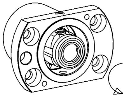
2—Drehen Sie den HN63C-Spannzylinder nun um 90°, sodaB die kleine Einfrasung auf der Seite des Spannzylinders sich unter dem Gewindestift befindet, der im Einsatz sitzt. Die Bohrung am Flansch und die Spannschraube am Spannzylinder sind nun in einer Linie.
