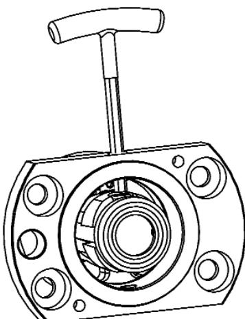
4—Zur Montage und Demontage der HSK63A-Werkzeuge, schrauben Sie mit dem 5mm-Inbusschlüssel im Uhrzeiger- und Gegenuhrzeigersinn die Klemmschraube auf den HN63C-Spannzylinder auf und zu.
