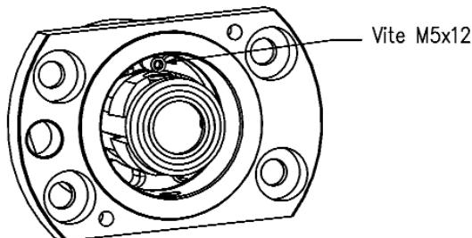
3—Schrauben Sie den M5x12 Gewindestift fest ein, sodaB der HN63C-Spannzylinder festgehalten wird.
